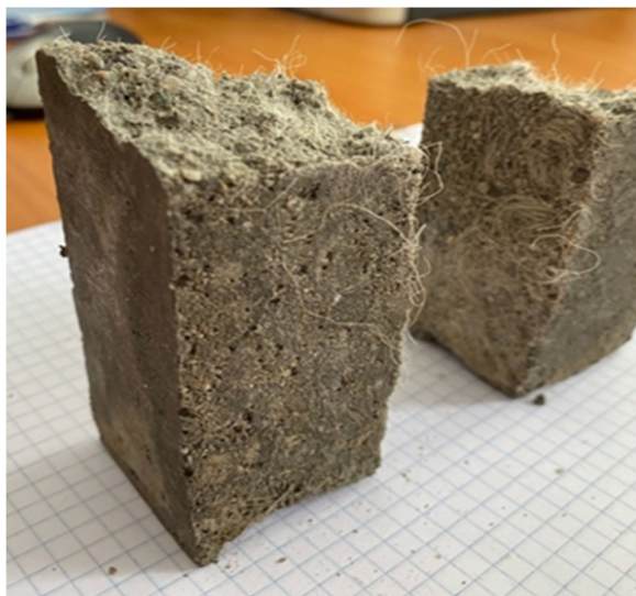
Figura 9. Probele după testarea rezistențelor mecanice la 7 zile
