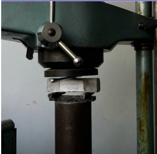
Figura 2. Rezistența la întindere prin încovoiere
