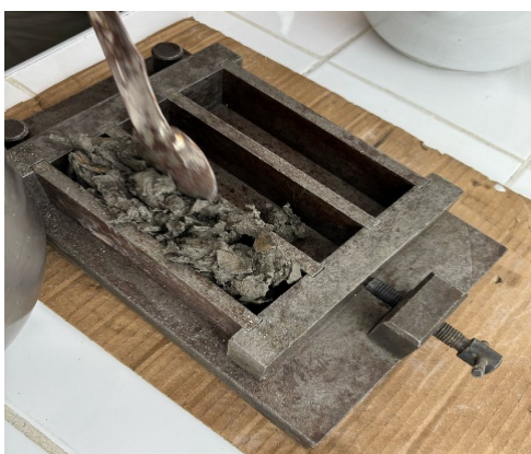
Figura 5. Introducerea compoziției în epruvete
