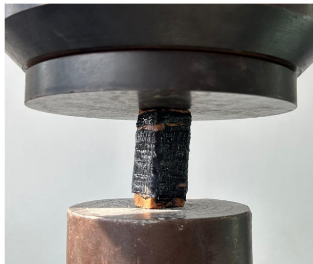
Figura 2. Epruveta între platanele presei.
