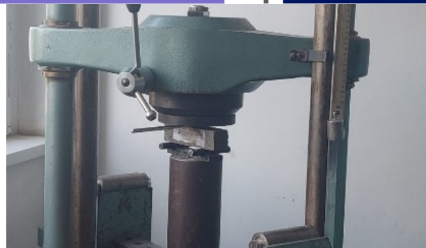
Figura 2. Rezistența la întindere prin încovoiere
