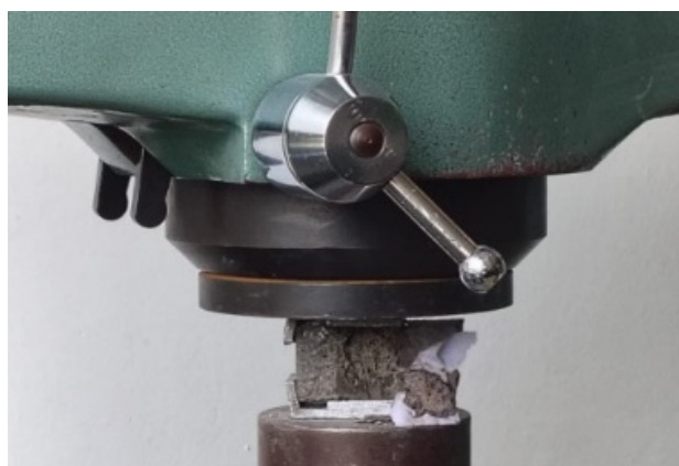
Figura 4. Rezistența la compresiune
