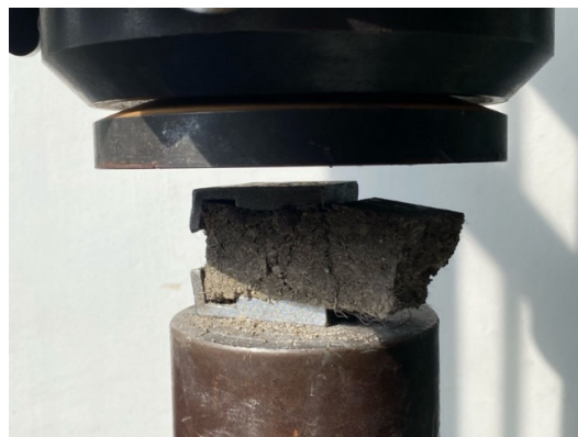
Figura 7. Rezistența la compresiune la 7 zile
