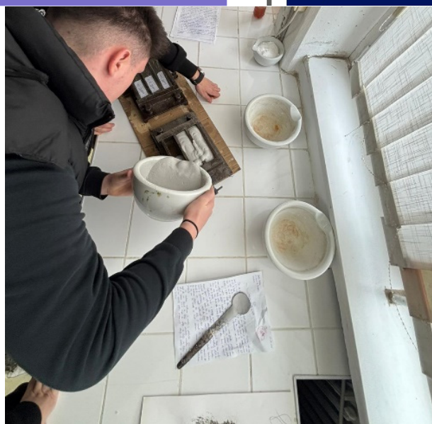
Figura 3. Turnarea amestecului în prisme
