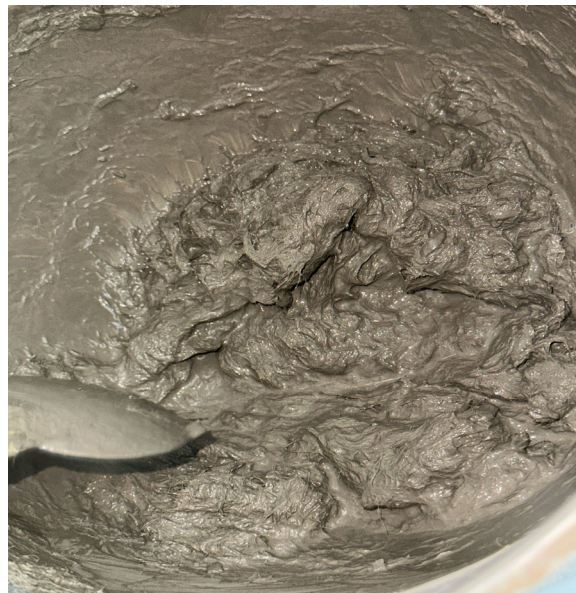
Figura 14. Consistența amestecului cu ciment
