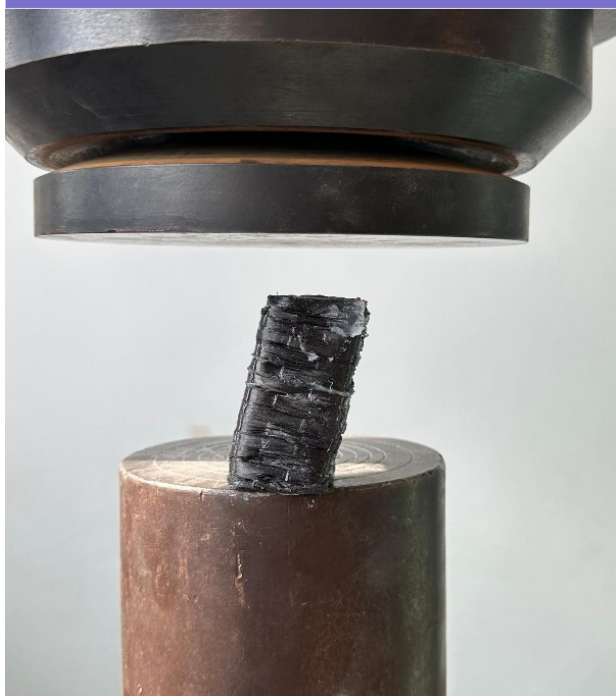
Figura 3. Epruveta deformată în urma testării
