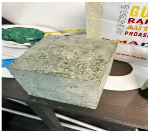
Figura 4. Blocul de beton cu chiștoace
