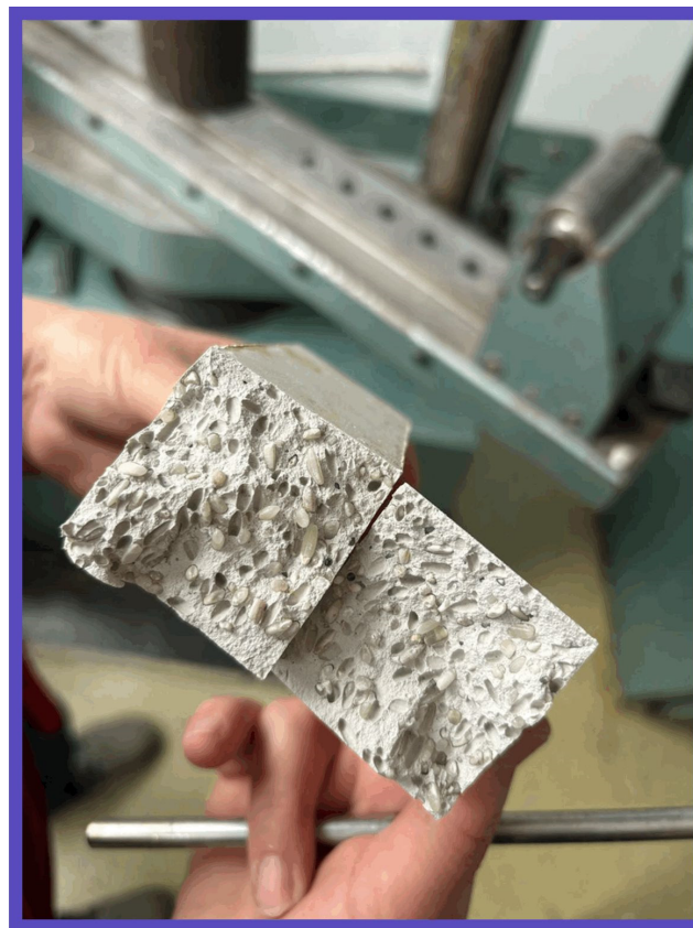
Figura 1. Mostră cilindrică din compozit ghips + boabe de orez [4]
