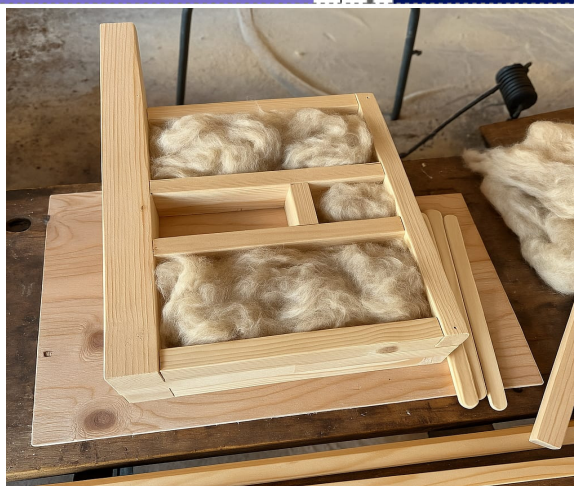
Figura 22. Panou izolat cu lână
