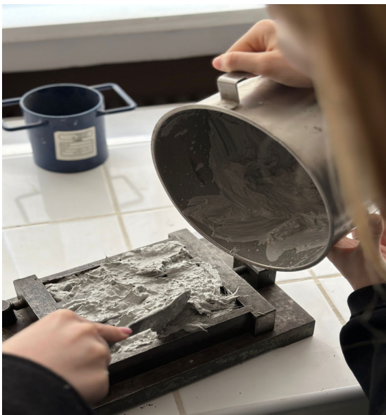
Figura 13. Epruvetele cu ipsos, lână și rumeguș
